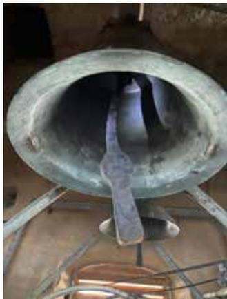
Im Winter ist auf der Lisna das elektrische Geläute ausgefallen. Verursacht wurde das durch einen technischen Defekt, der dazu geführt hat, dass ein Klöppel abgebrochen ist und ein anderer stark verbogen wurde. Die Anschaffung neuer weichgeschmiedeter Klöppel und die Reparatur kostete 2.696,40 Euro.
